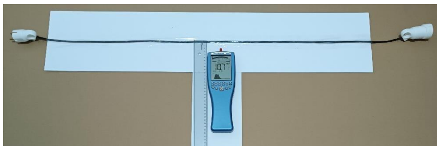
Figura 1 – Montagem inicial onde o comprimento dos cabos deve ser bastante superior à zona onde se desloca o Spectran.
