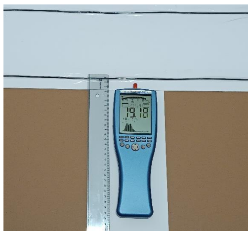
Figura 3 – Medição do campo magnético com os condutores afastados. O Spectran deve percorrer ambos os condutores para se perceber a simetria total do problema.
